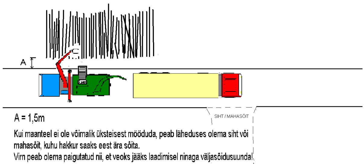
Joonis 1. Hakkimine, kui hakkur asub konteinerveoki taga
